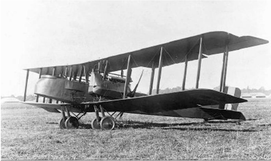
Le Gotha Bomber - Bombardier lourd de l'armée allemande – Plafond de 6500 m – vitesse 140 Km heure – Rayon d'action de 840 Km avec 14 bombes de 25 Kg – 3 mitrailleuses parabellum MG 14 de 7,92 m/m
