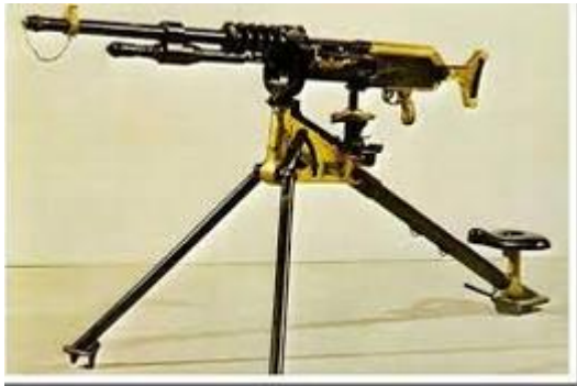
Mitrailleuse Française Hotchkis – St Etienne Portée 4500 m - 8 m/m – 60 coups minute
