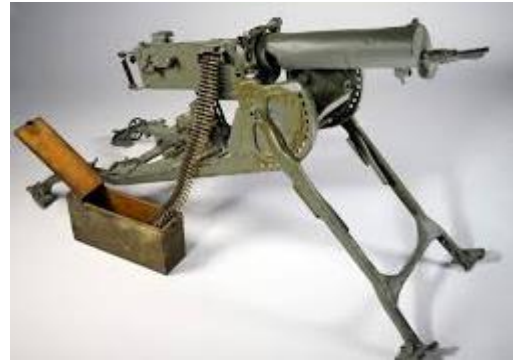
Mitrailleuse Allemande Maxime Portée 3600 m.- 7,92 m/m – 500 coups minutes
