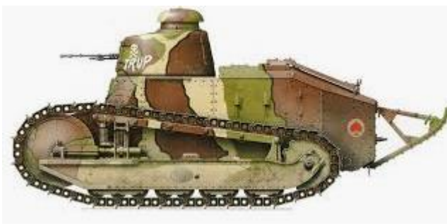
Renault FT 17 avec Mitrailleuse Hotchkiss de 8 m/m
